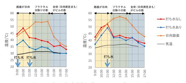
図 4.52 路面温度の経時変化(左:7月29日、右:8月9日)
