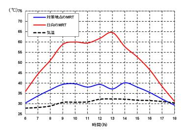
図 4.33 MRT の経時変化の計算結果
