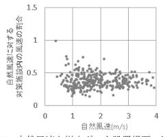
図 4.55 自然風速と樹木ポット設置場所の風速の関係
