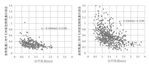
図 4.51 自然風速と対策施設内の風速の関係(左:北風の場合、右:南風の場合)
