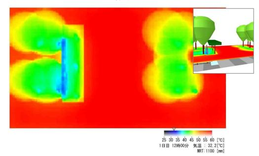
図 4.32 12 時の MRT の面的分布の計算結果
