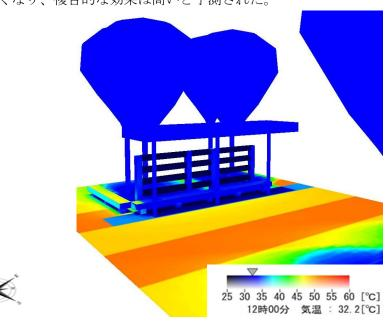
図 4.30 12 時の表面温度分布の計算結果
