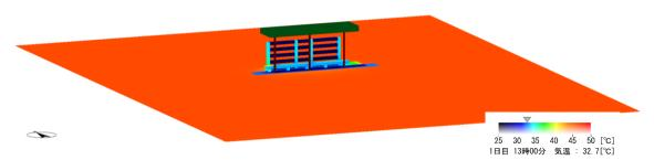
図 4.64 作成した 3D モデル (周囲に建物等は存在しないものとしてモデルを作成)
