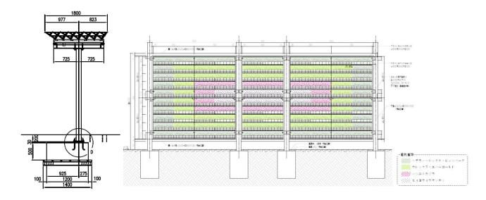
図 4.35 設計立面図 (左:フラクタル形状の日除け、右:緑化冷却ルーバー)
