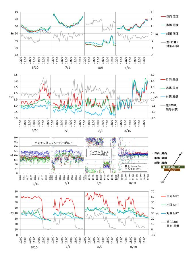
図 4.45 熱環境測定結果(湿度、風速、風向、MRT)
