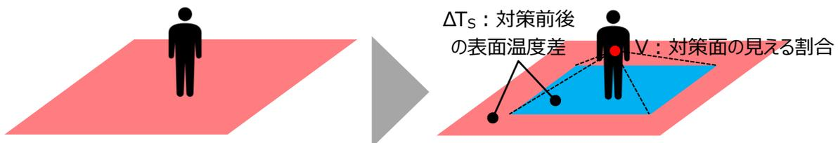
図 2 路面の高温化抑制対策のイメージ
