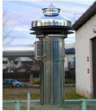
図 4.3 気温センサーを入れる通風筒の例（断面と概観）<sup>109</sup>
