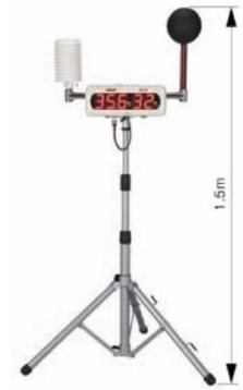
図 4.7 WBGT 測定装置 (演算型) の例
