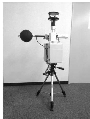
図 4.2 温熱 4 要素を測定する機器の例
