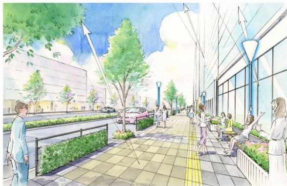
再帰反射性のガラス面とブロック、車道からの放射熱を遮蔽する緑化フェンスによる歩行空間を表現した。
