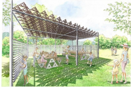
樹木の葉を模した熱くならない日除けと水が滴る冷却ルーバーによる休憩所を表現した。
