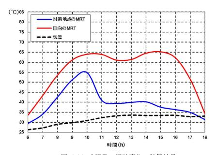
図 8.30 MRT の経時変化の計算結果
