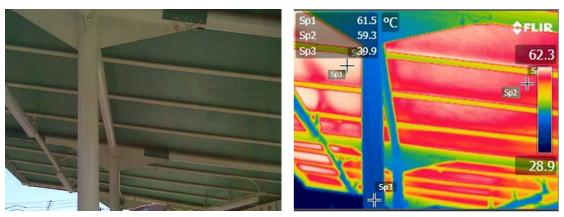
図 8.12 既設屋根のテント膜の表面温度分布 (7/26 14:01、33.0℃)
