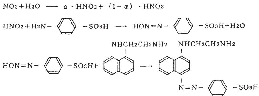
この呈色度を吸光光度法により測定し、二酸化窒素を定量する。
