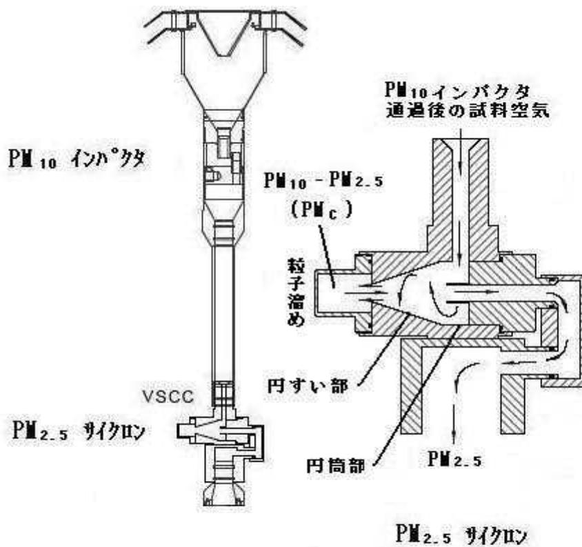
図 2.1-2 米国 EPA 連邦等価法 (FEM) に認定されている PM<sub>2.5</sub>分粒装置
