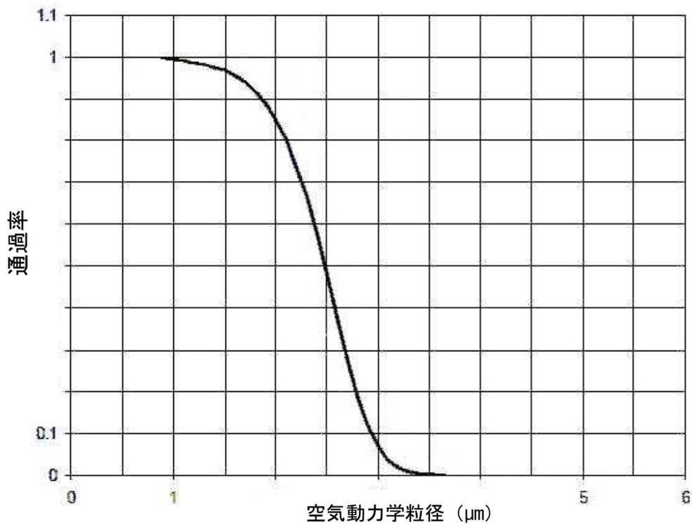
図 2.1-1 PM<sub>2.5</sub>分粒装置の通過率特性
