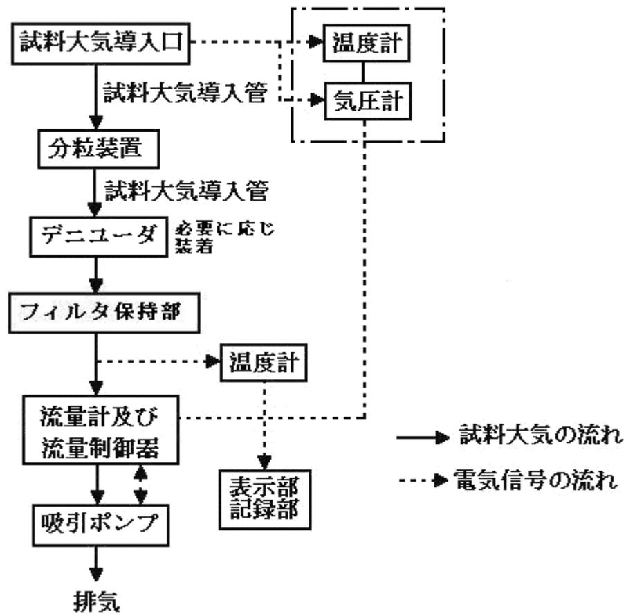
図 2.1-4 捕集装置の基本構成
