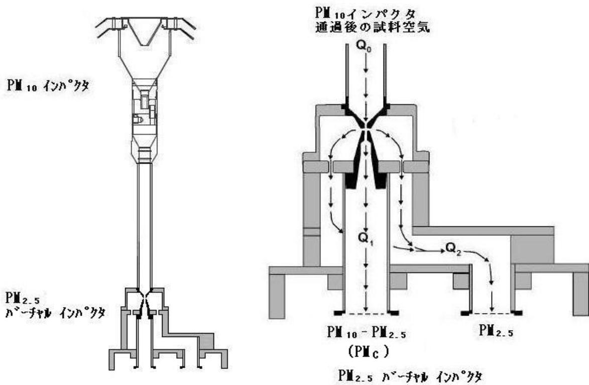
図 2.1-3 バーチャルインパクタの概要図
