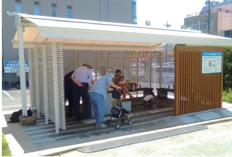
日よけ、保水性ブロック、水景施設、冷却ルーバー、冷却ベンチを組み合わせたバス停の例。
