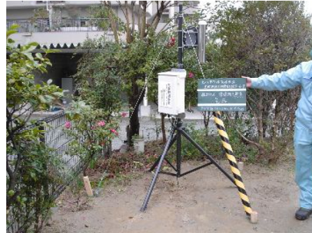
図 4.4 ヒートアイランド観測機器の設置例 大阪府東大阪市西岩田付近 資料) 環境省
