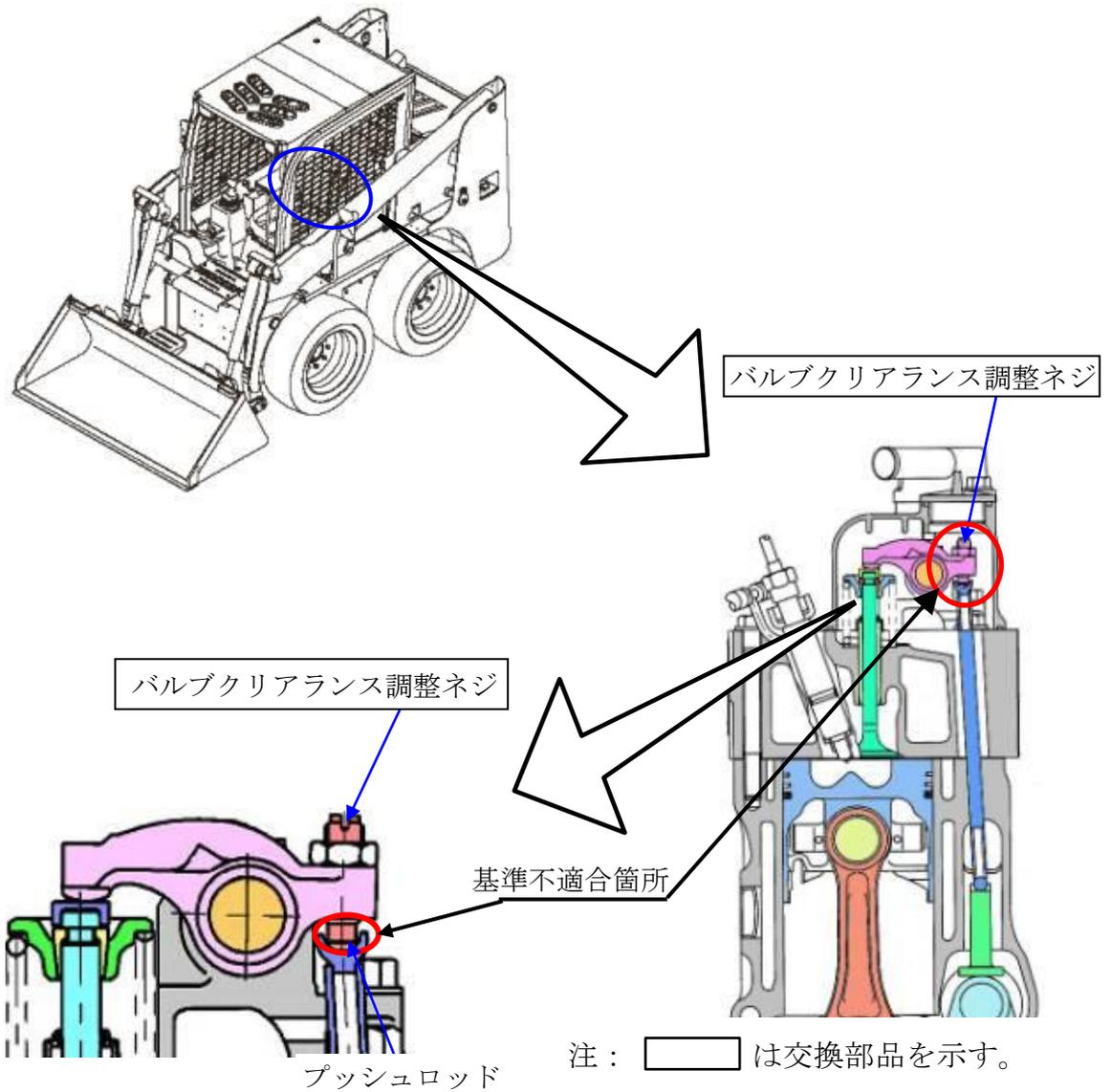
（原動機の吸排気バルブのバルブクリアランス調整ネジにおいて、焼き入れ不良品が混入したため、プッシュロッドとの接触面が早期に摩耗するものがある。そのため、そのままの状態で使用を続けると、バルブの開度が不足して正常な燃焼ができず、排出ガスの排出量が基準値を超えるおそれがある。）
