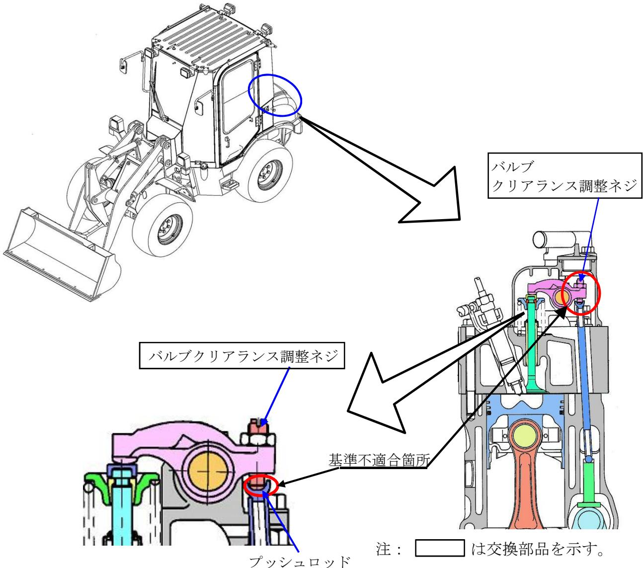
原動機の吸排気バルブのバルブクリアランス調整ネジにおいて、焼き入れ不良品が混入したため、プッシュロッドとの接触面が早期に磨耗するものがある。そのため、そのままの状態で使用を続けると、バルブの開度が不足して正常な燃焼ができず、排出ガスの排出量が基準値を超えるおそれがある。
