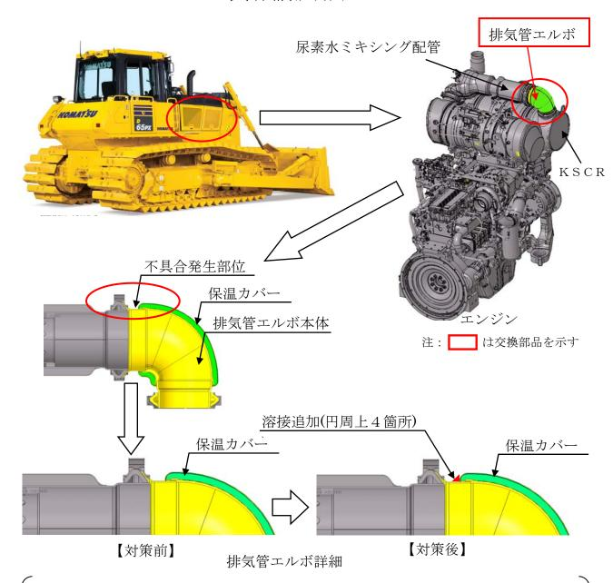
当型式番号の特定特殊自動車に搭載されたディーゼルエンジンの排気管エルボにおいて、排気管エルボを覆っている保温カバーが固定されていないため、原動機の振動により排気管エルボ本体と接触し損傷させるものがある。そのため、そのままの状態で使用を続けると、破断し排気ガスが漏れるおそれがある。
