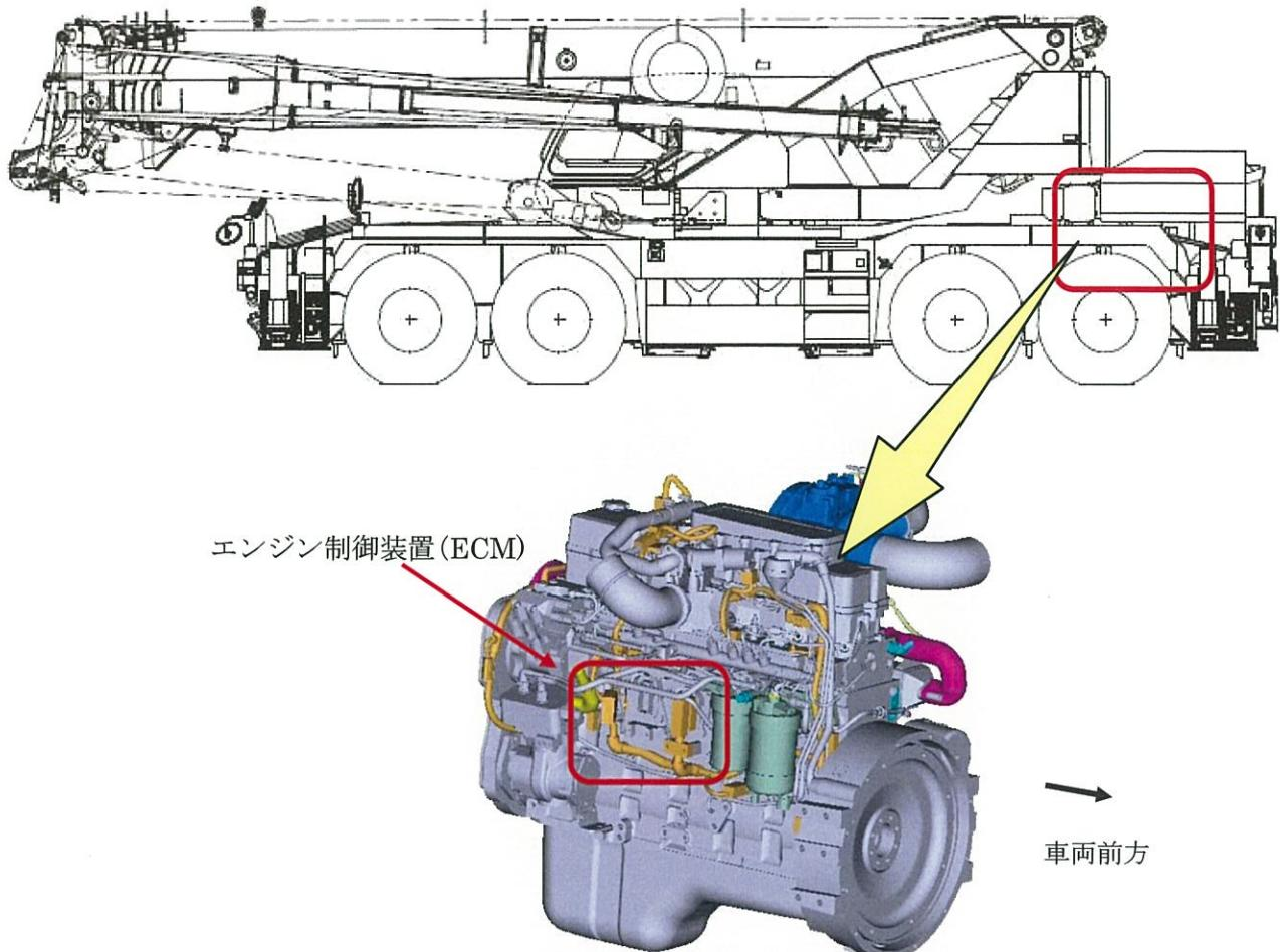
ホイールクレーンのエンジン制御装置（ECM）が、エンジン圧縮開放ブレーキを作動させる信号回路へ誤信号を発するため、エンジン圧縮開放ブレーキが正常に作動しないことがある。そのため、そのままの状態で使用を続けると、エンジン出力の低下若しくは白煙を排出し、最悪の場合、エンジンが停止するおそれがある。
