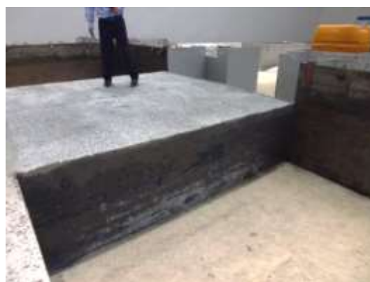
写真6 焼却灰を圧縮硬化したブロック (ブロック：3m×3m×深さ0.8m)
