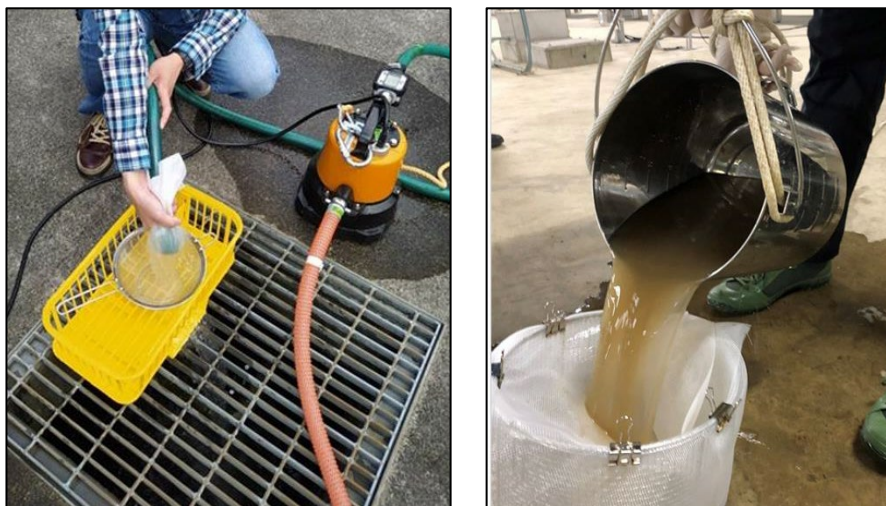
図 5 採水及びろ過状況（左図：ポンプ採水、右図：バケツ採水）
