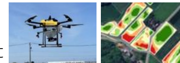
【スマート農業技術の活用事例】 リモートセンシングデータを活用した 施肥マップに基づくドローン施肥
