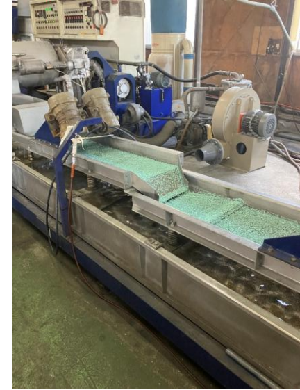
押出機で造粒されたペレット
