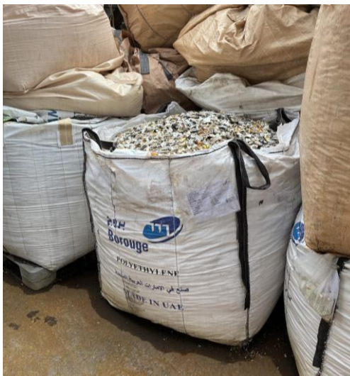
異物が混在している
