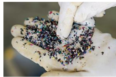
被覆材残渣物（PVC他）
