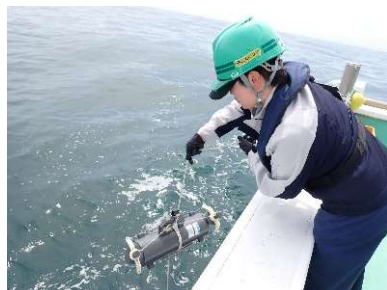
トリチウム分析用海水の採取 (二スキュン採水器の投下)
