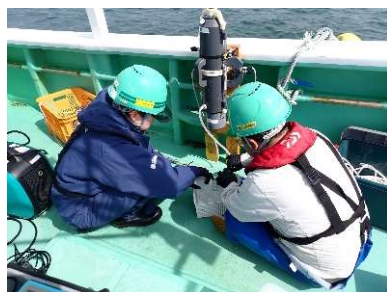
トリチウム分析用海水の採取 (二スキュン採水器から海水の分取)
