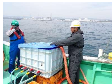
主要7核種分析用海水の採取 (大型容器への採水)
