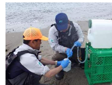
トリチウム分析用海水の採取 (20L容器から海水の分取)
