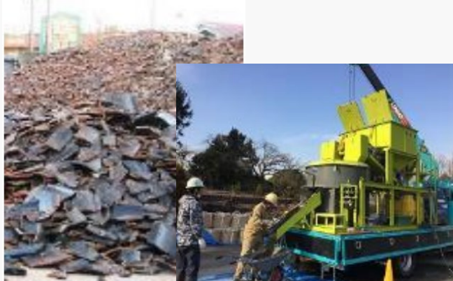
▲ 車載式舗装材 製造プラント「モバコン」
