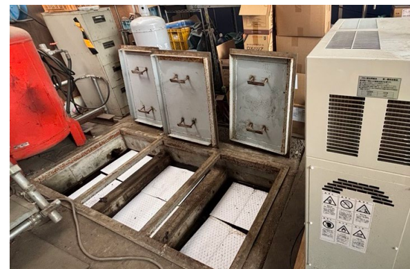
油水分離装置
