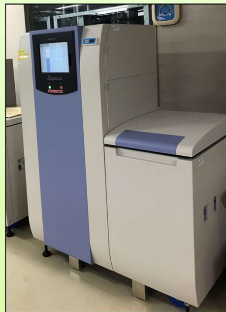
○液体シンチレーションカウンタ
