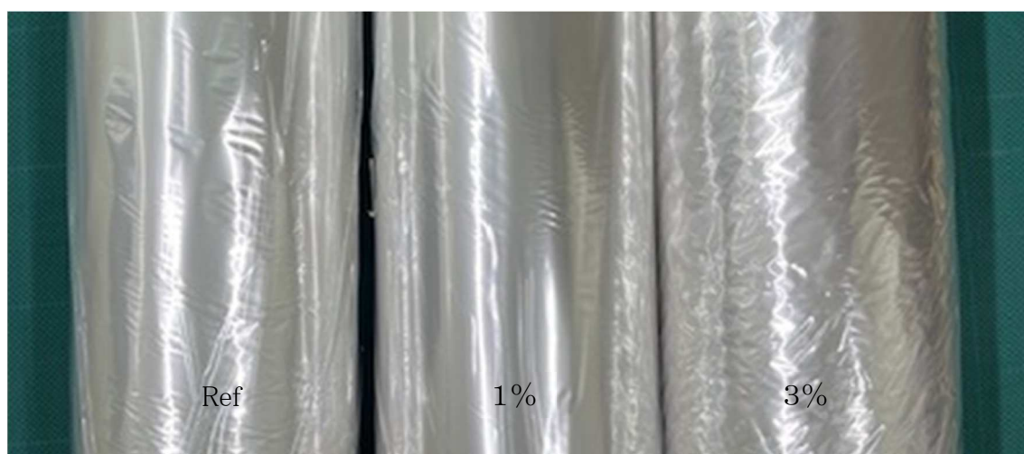
図 90 (左)バージン NY 樹脂 (中)ラミネート回収 NY 樹脂1% (右)ラミネート回収 NY 樹脂3%
