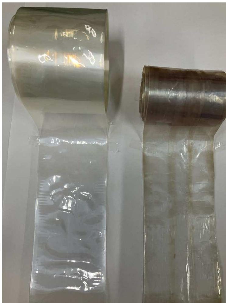
図 77 (左)バージン NY 樹脂使用 (右)ラミネート回収 NY 樹脂使用
