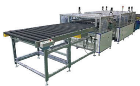
太陽光パネルリサイクル設備
