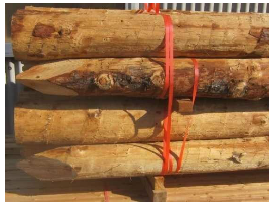
円柱加工を行っていない杭の例
