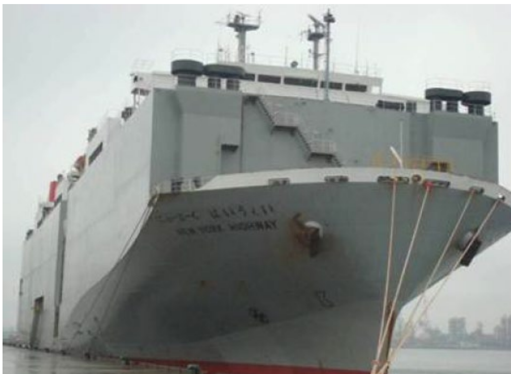
川崎汽船、太陽日本汽船共同保有の自動車船 1985年大島造船建造、日本籍、NK船級、総トン数 45,706GT 軽貨排水重量トン 12,251LDT、全長174.61m、全幅32.2m
