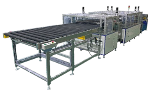
太陽光パネルリサイクル設備
