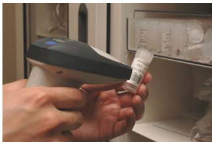
写真 1：保管時のバーコードの読み取り作業
