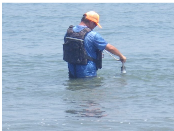
別図 11-58 水深、塩分測定(CTD 測定) (令和 7 年 7 月 25 日撮影)
