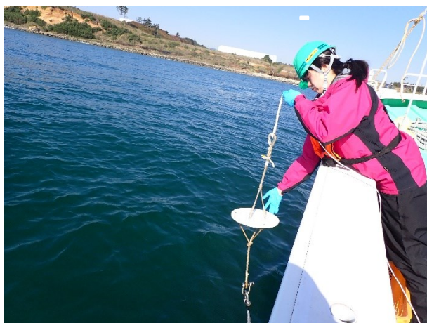
別図 11-11 透明度の測定 (令和 7 年 4 月 22 日撮影)
