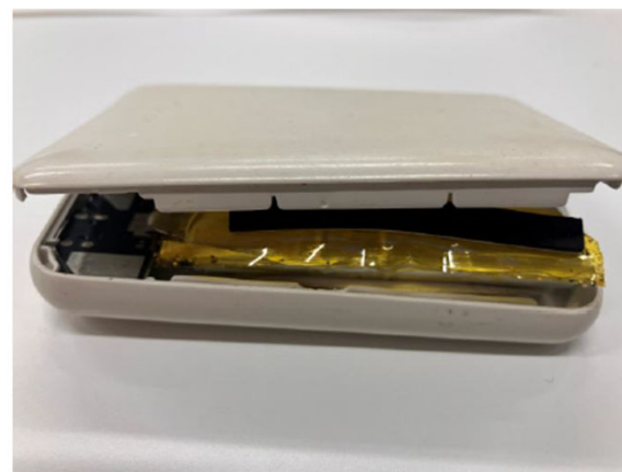
膨張したリチウムイオン電池
