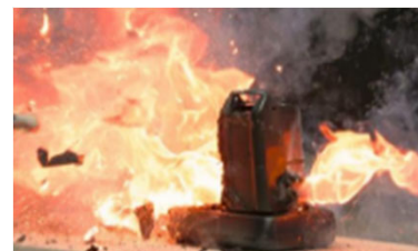
電動アシスト自転車用バッテリーの発火 【NITEの再現実験】
