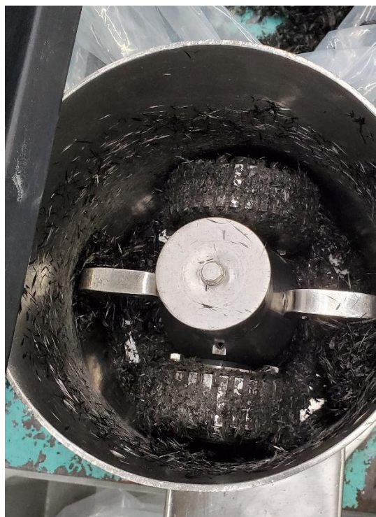
図 3-3-4 ディスクペレッター装置内部構造
