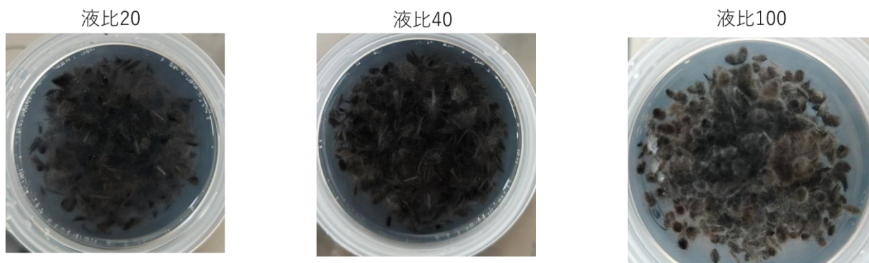
図 3-3-8 rCF の水に対する分散性(液比依存性)
