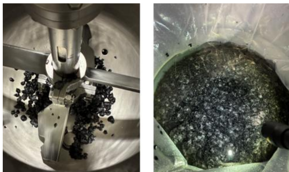
図 3-1-12 6mm シート状廃材使用時の抜き出し状況(左:槽内、右:抜き出したサンプル)
