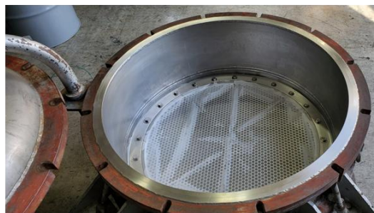
図 3-1-9 分解に使用したムッチェ(左:外観、右:内部)
