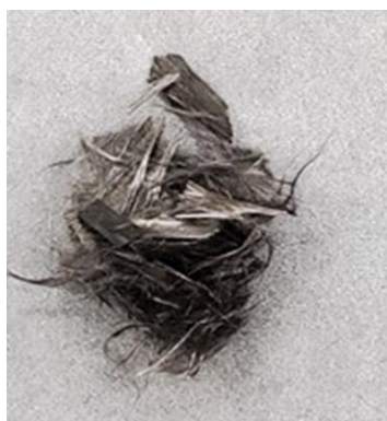
図 3-1-2 常圧分解試験後の CFRP サンプル(KOH 使用)
