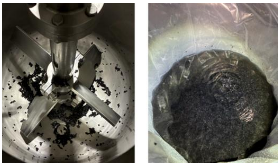
図 3-1-11 3mm シート状廃材使用時の抜き出し状況(左:槽内、右:抜き出したサンプル)
