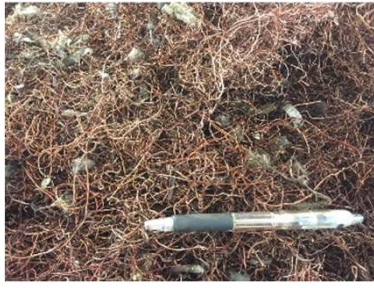
破砕後の回収素材（銅濃縮物）
