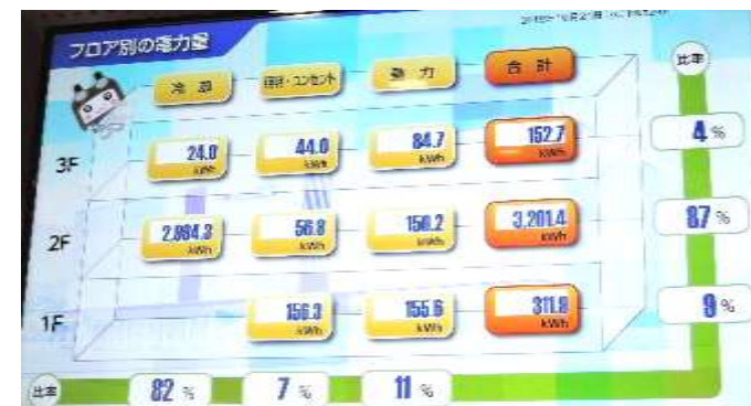
<BEMS画面：電力使用状況を電光掲示板で常に掲示>
