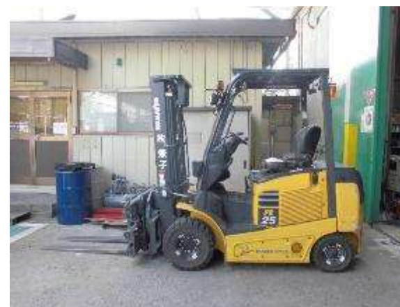
2.5t積 急速充電搭載電動フォークリフト
