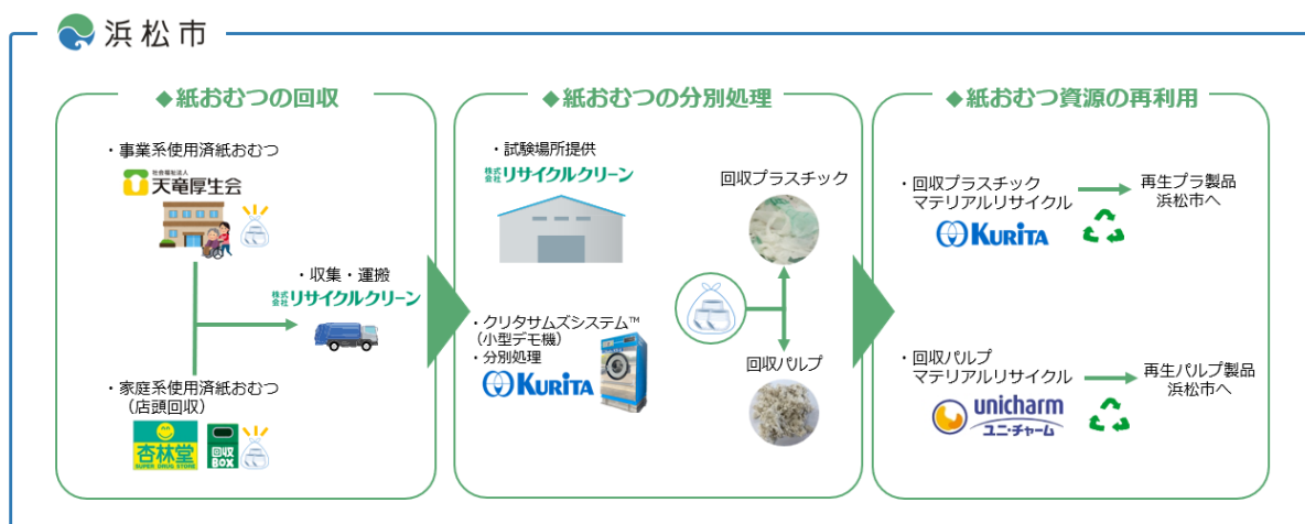
図 5-32 使用済紙おむつ資源循環実証事業の全体フロー
