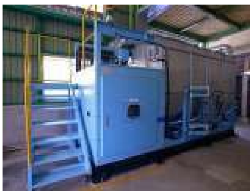
図 5-13 紙おむつ燃料化装置(600kg/日処理)
