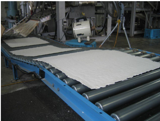
図 5-3 パルプシート製造工程
