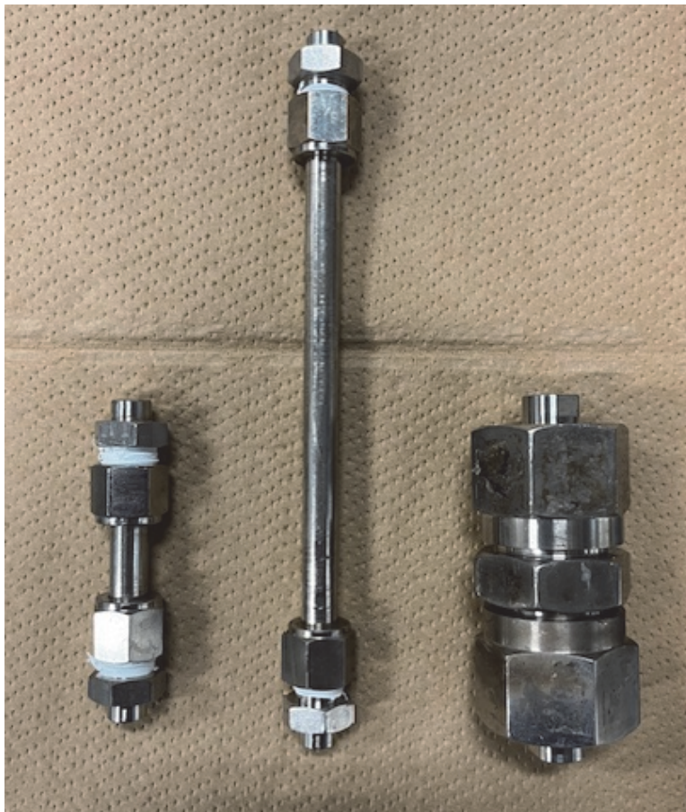
写真 5. カラム管のサイズ: 左から、7.6mm \Phi ×5cm、7.6mm \Phi ×15cm、20mm \Phi ×5cm
