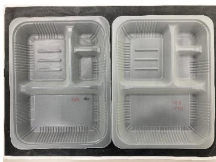
左：300 μm 従来シート 右：300 μm 剛性改良シート
