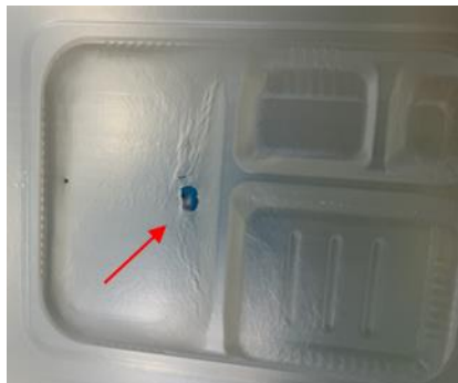
図 57 成形ショット板のランダムな破れ・穴あき写真
