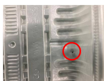
微細な穴あき箇所
