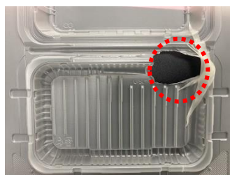
図 14 フードパック・弁当容器本体の試作結果（単発成形機）
