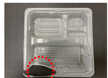
図 14 フードパック・弁当容器本体の試作結果（単発成形機）
