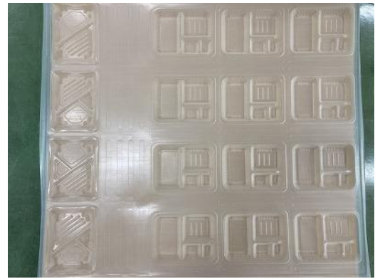
既存製品と PHBH 専用設計の比較成形
