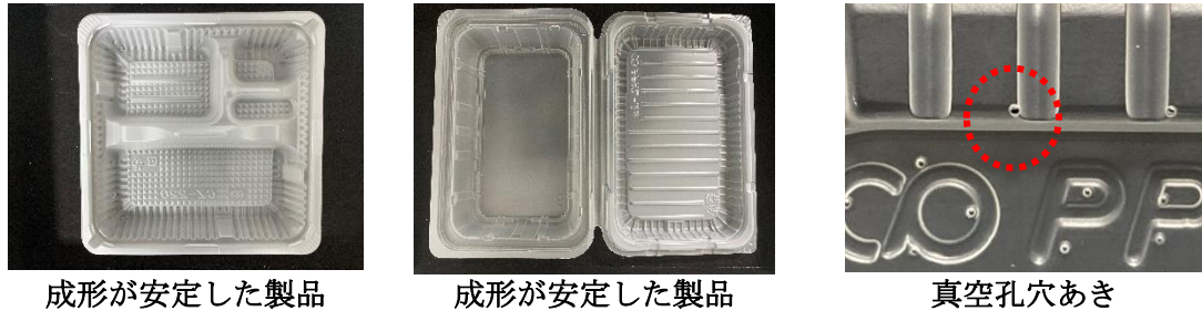
図 15 フードパック・弁当容器本体の試作結果（単発成形機）
