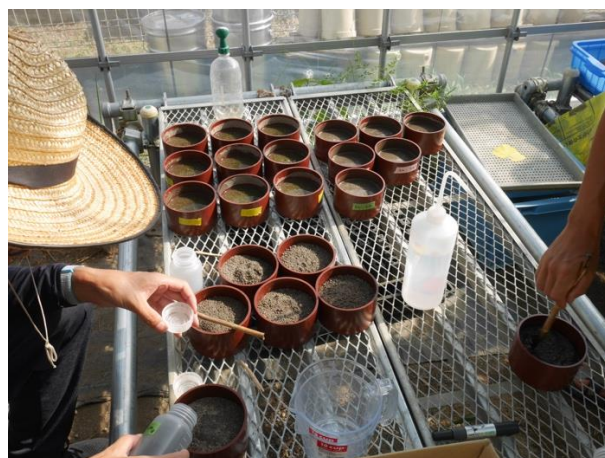
図 146 ノイバウエルポットに 400 g の風乾土壌をとり、ここに消化液を含む 130 mL の水分を混和して代をかいた。
