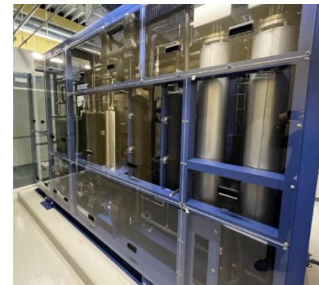
水素製造装置
