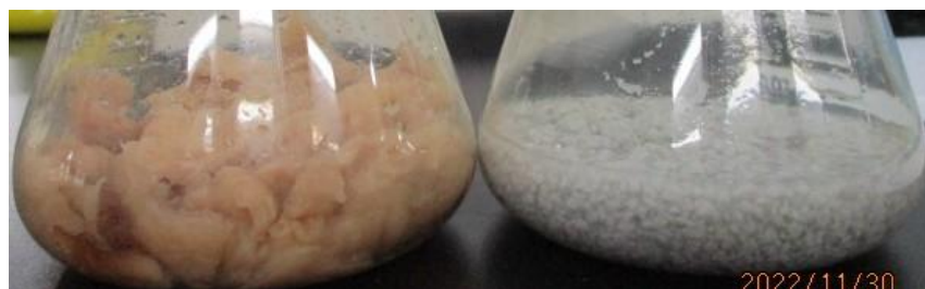
③広葉樹クラフト漂白前パルプ ④脱墨古紙パルプ
