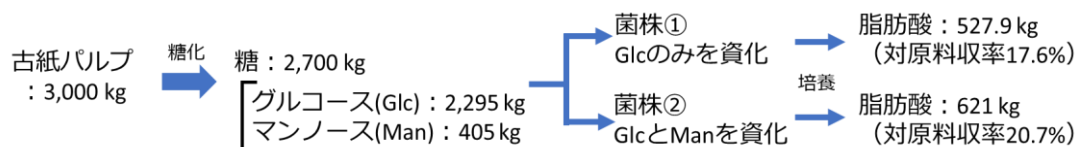
図5-25 古紙由来糖質を原料とした場合の脂肪酸収率のシミュレーション
