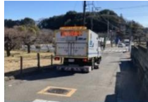
(空洞探査車による調査)
