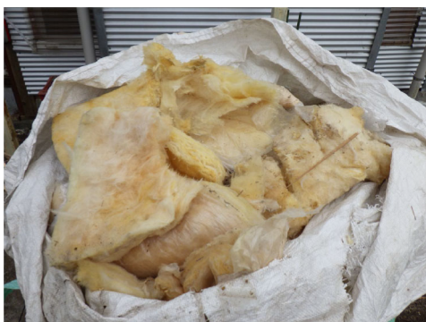
図3.8 グラスウール分別状況
