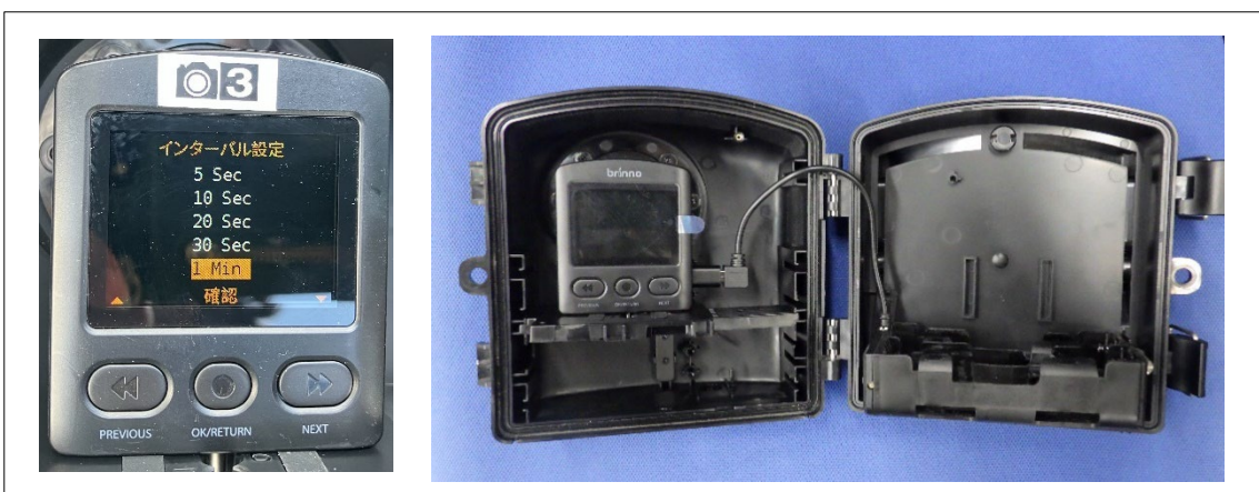
図 2-24 高機能タイムラプスカメラ(TLC2000)
