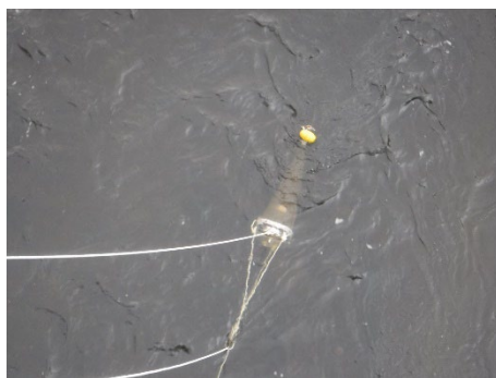
図 3-13 上部に浮きを取り付けたネット
