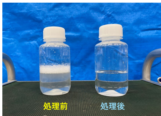
写真 2.2.1 処理前後の泡立ち状況（5 秒間振とう後、5 秒間静置）
