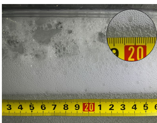
写真 2.2.2 本試験（連続式）における水面付近の泡沫（気泡サイズ）の状況
