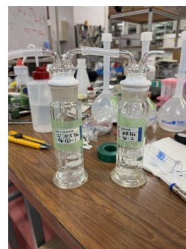
インピンジャーにて吸収液に吸収 (ふっ素ガス)
