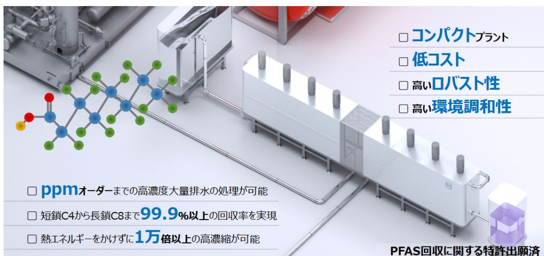
図1 エマルションフローによる PFAS 回収プラントの CG イメージ図
