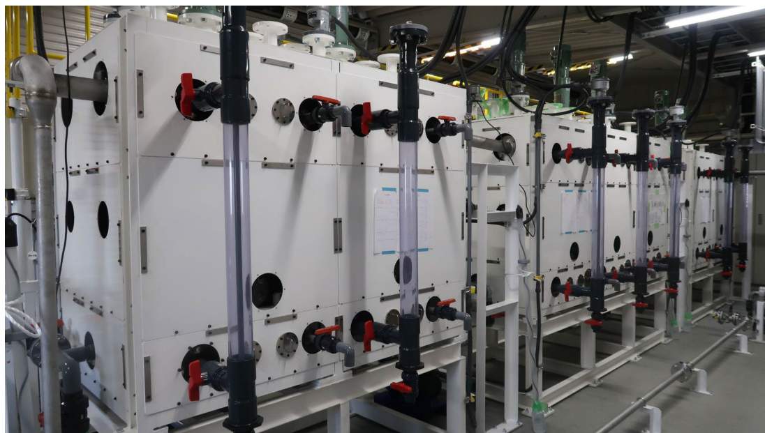
図 35 EFT 社内に設置されている 500L/段でのエマルションフローの 7 段装置
