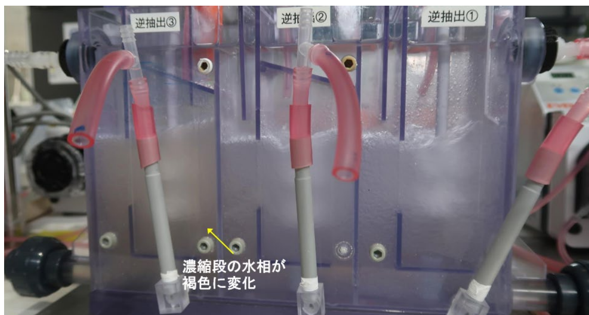
図 16 水 1 でのエマルションフロー試験における濃縮段（逆抽出③）での水相の着色
