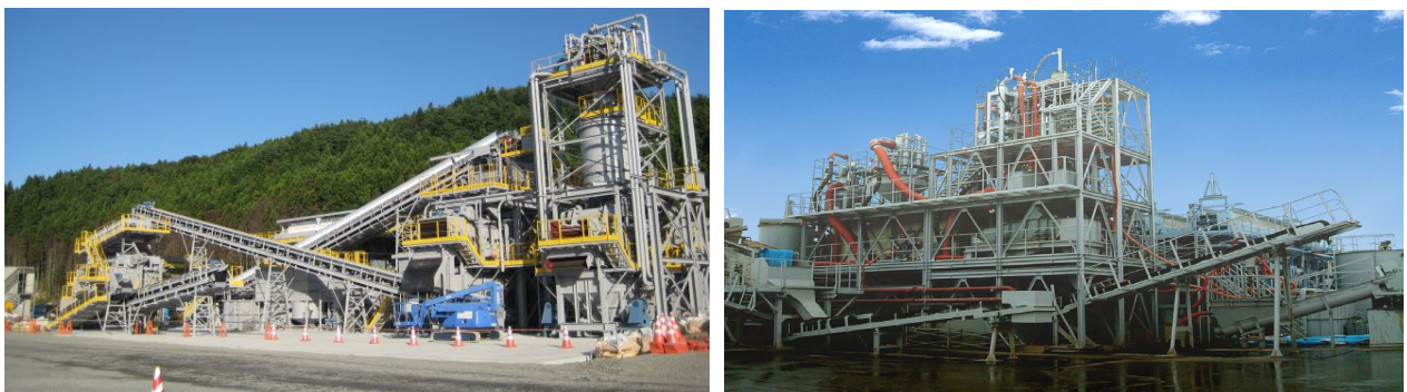
図-3.8 オンサイト土壌洗浄プラントによる PFAS 汚染土壌の浄化(イメージ)
