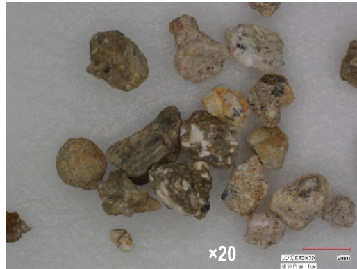
(b) 水洗い後の土壌粒子表面, 砂分(63 µm~2 mm)
