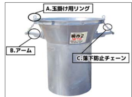
図-5 大型土のう製作治具
