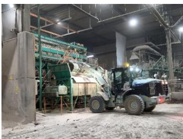
図-26 土壌試料投入状況
