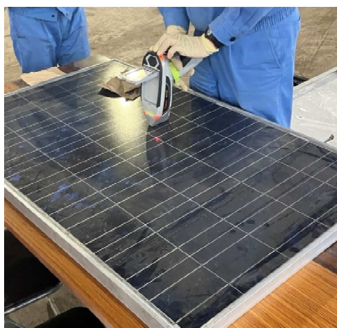
図 2-12 ハンドヘルド XRF によるガラス中の含有物質測定の様子
