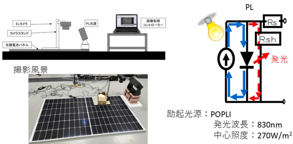
図 3-19 PV パネル向け PL 測定システム PVX330 + POPLI(アイテス製)の概要 (アイテス提供)
