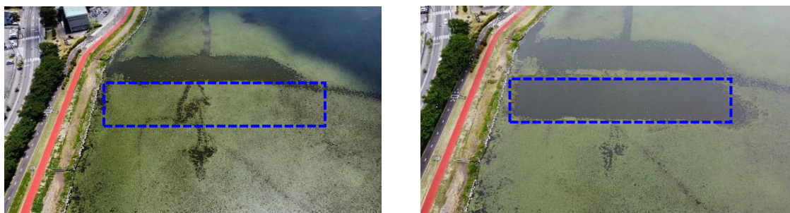
図 2-3 ドローンによるヒシ繁茂状況の調査例(左:刈り取り前、右:刈り取り後)
