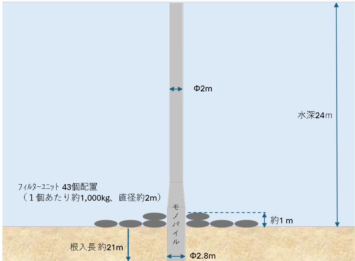
図-3 補助部材（フィルターユニット）配置状態
