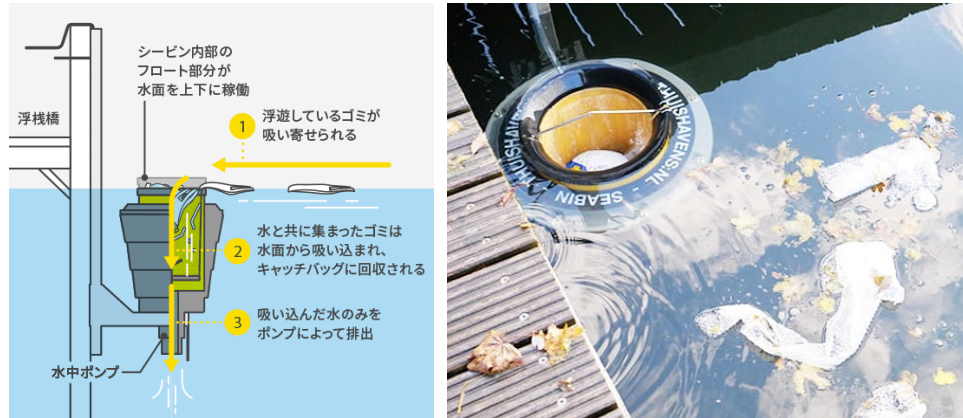
Seabin の仕組みと回収の様子
