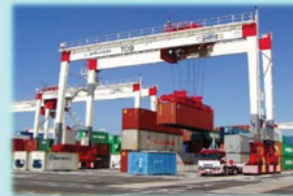
トランスファークレーン
